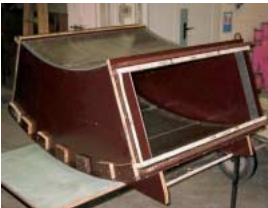
Schalung eines Segmentes Mold of a segment Bild: TU Dresden
